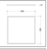
220-240V 50/60Hz 36W C€ <sup>IK</sup>/<sub>P</sub> RG <sup>UGR</sup>/<sub><19</sub> <sup>CRI</sup>/<sub>≥00</sub> IP40
