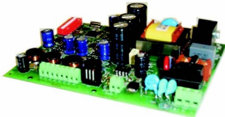
Il CONTROLLER DMX è stato progettato per alimentare LED collegati in serie funzionanti a 350mA.
