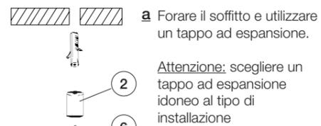
b Fissare la boccola (2) serrando a fondo la vite (6).
