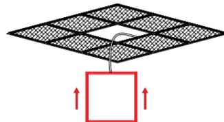
1. Ruotare il pannello di 45° ed inserirlo all'interno del controsoffitto evitando di esercitare una forte pressione per non danneggiare il pannello.
