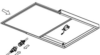
2. Collegare i conduttori di rete all'alimentatore rispettando le polarità e la classe di isolamento dell'apparecchio, quindi collegare il connettore in uscita dall'alimentatore al connettore in uscita dal pannello (Fig.1).
