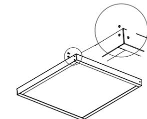
3. Inserire il pannello nel telaio fino a fine corsa. Prendere il quarto lato del profilo e serrare tramite le apposite viti.
