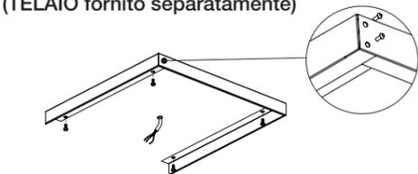
1. Assemblare 3 lati del profilo come in figura tramite le apposite viti. Fissare a soffitto il telaio tramite viti e tappi ad espansione mantenendo i lati del profilo in squadra tra loro. **Attenzione:** scegliere un tappo ad espansione idoneo al tipo di installazione.
