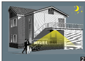
In presenza di scarsa luce, il sensore accende l'apparecchio quando rileva movimento
